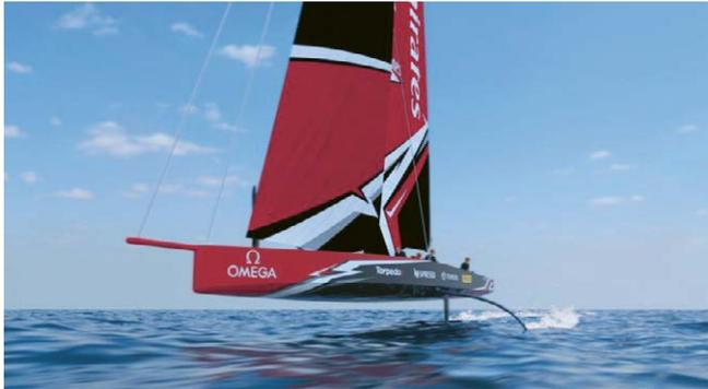
Jawohl, das Teil fliegt noch höher, noch schneller (über 50 kn gemäss theoretischen Berechnungen) und sollte noch stärker sein. Genau – stärker! Gemäss Simulation sind die vorgesehenen Foils zu schwach und brechen... Und irgendwie kommt beim Ingenieur ein ungutes Gefühl auf bezüglich Stabilität dieses Zweibeins (das Luv-Foil soll tatsächlich hochgehoben werden).
